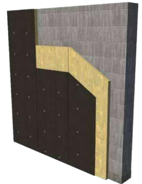
Sistema forrado para muros de mampostería.
